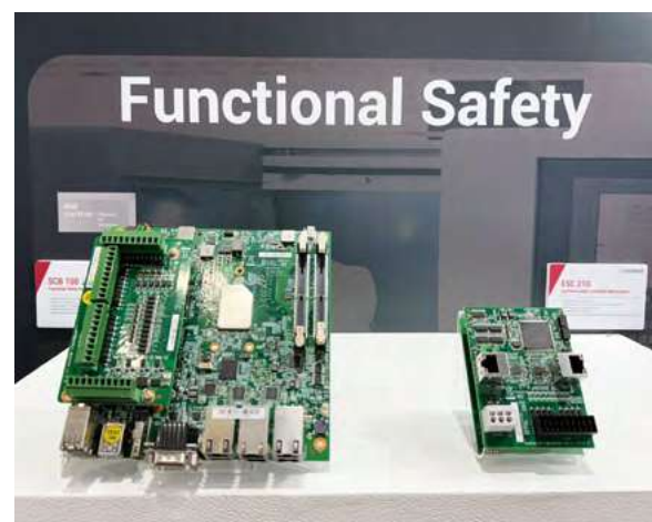
創博 SCB100 以及 ESC210 功能安全控制器可搭載於各類工業協作型及移動式機器人、四足機器人、人形機器人等產品
